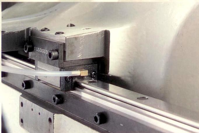
La lubrificazione centralizzata delle guide lineari e delle viti a ricircolazione di sfere minimizza gli interventi di manutenzione ordinaria, oltre che contribuire alla massima precisione di lavorazione.
